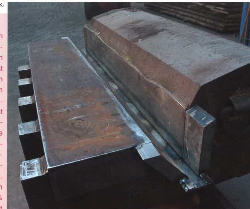
Figuur 3 Elk proefstuk werd zwaar opgespannen met vijf brugplaten
